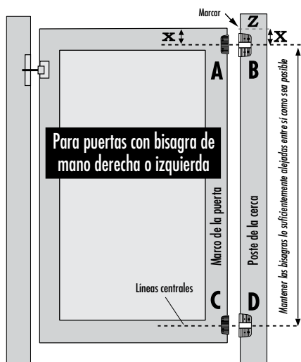
Ejemplo de una puerta con bisagras de mano derecha
